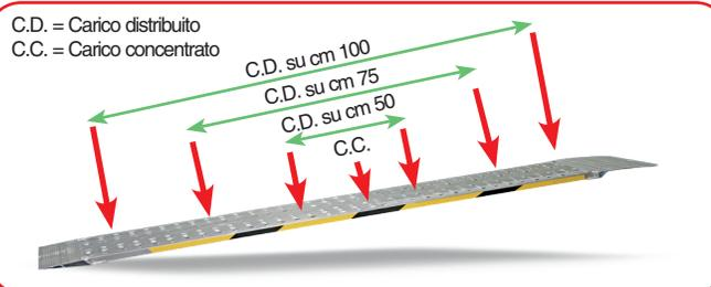
Rampe leggere senza bordo. Il profilo con altezza 35 mm consente di costruire una serie di rampe molto leggere e comode per il carico scarico di piccoli mezzi. La bugnatura antiscivolo garantisce la massima aderenza ai mezzi. Le rampe pieghevoli da 1,5 - 2,0 e 2,5 metri sono ideali per i piccoli automezzi che possono trasportarle facilmente. Perfette per moto, camper, furgoni, hobby, giardinaggio, macchine per la pulizia, edilizia, quad, ecc.
