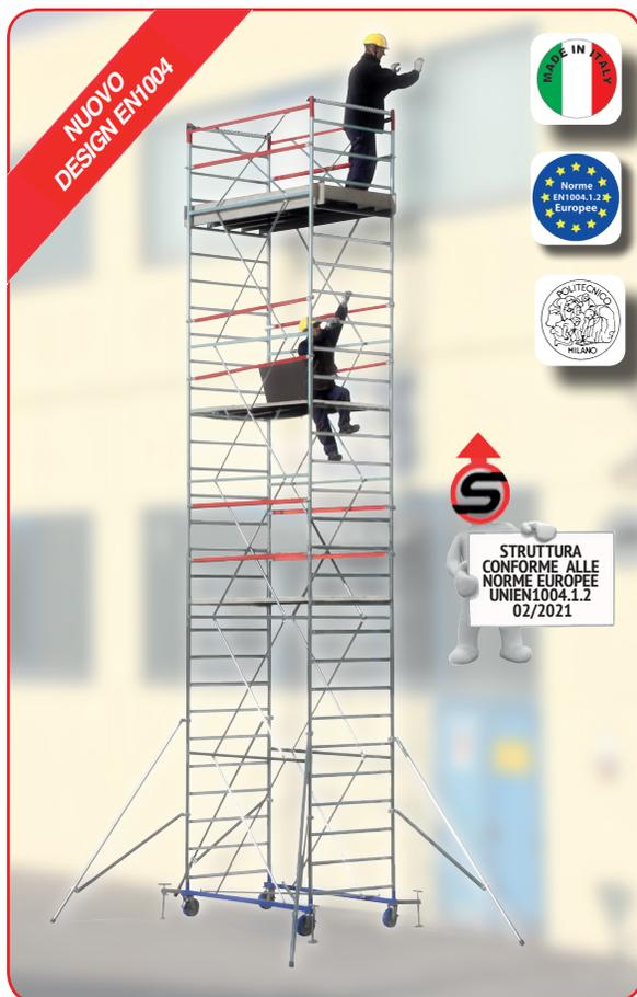
Il trabattello EuroTech è realizzato in acciaio FE360 zincato elettroliticamente contro la ruggine. Offre grandissima sicurezza di lavoro e facilità di montaggio. Le spalle che presentano una distanza tra i poli zigrinati di 30 cm per una comoda salita dell'operatore. Le crociere di base sono uguali a tutte le altre. Realizzato con le nuove Norme Europee UNIEN1004-1-2 2021.
