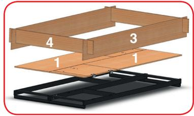
7) **Il nuovo piano di lavoro 2023 (impalcato)** consiste in un telaio realizzato in alluminio nervato o acciaio verniciato sui cui viene inchiodato un piano in legno antisdrucchiolo e resistente agli agenti atmosferici. Il piano viene completato con 4 tavole fermapièdi. Una botola permette il passaggio degli addetti all'interno del trabattello. Con due botole è possibile il montaggio (A.L.B.) in conformità alla Norma Europea UNIEN1004.1.2. (vedi pag. 7).
