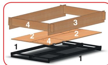
**7) Il nuovo piano di lavoro 2023 (impalcato)** consiste in un telaio realizzato in alluminio nervato o acciaio verniciato sui cui viene inchiodato un piano in legno antidrucciolo e resistente agli agenti atmosferici. Il piano viene completato con 4 tavole fermapiedi. Una botola permette il passaggio degli addetti all'interno del trabattello. Con due botole è possibile il montaggio (A.L.B.) in conformità alla Norma Europea UNIEN1004.1.2. (vedi pag. 7).
