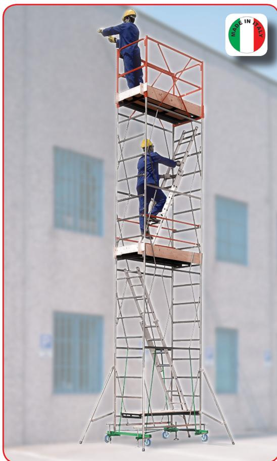
Il trabattello Dingo è realizzato in acciaio FE360 zincato elettroliticamente contro la ruggine. Offre grandissima sicurezza di lavoro e facilità di montaggio. Le crociere formano una struttura staticamente perfetta che non può subire torsioni anche a grandi altezze, fornendo inoltre un ampio spazio di lavoro in facciata. Ruote certificate con freno a pedale.
