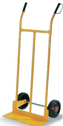
**Carrello portapacchi.** Carrello in acciaio verniciato con polveri epossidiche. Dotato di manopole anti infortunistiche con paramano di sicurezza. Gomme in plastica con portata cad. Kg 75, Ø 200 mm con mozzo in plastica. La struttura è costituita da tubolari saldati con Ø 25 mm.
