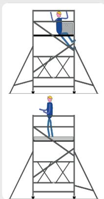
**Sistema A.L.B. (Attraverso La Botola)** per il montaggio dei parapetti stando seduti sul piano dei trabattelli **SERIE ROLLER PLUS, ROLLER E MILLENIUM S, SERIE SVELTOWER, EUROTECH, MAJOR, PROFESSIONAL.**
