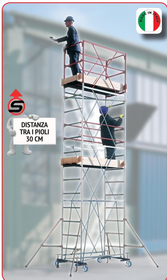
Il trabattello Euromedium è realizzato in acciaio FE360 zincato elettroliticamente contro la ruggine. Offre grandissima sicurezza di lavoro e facilità di montaggio. Le spalle che presentano una distanza tra i poli zigrinati di 30 cm per una comoda salita dell'operatore anche senza scalette interne. Ruote certificate con freno a pedale.
