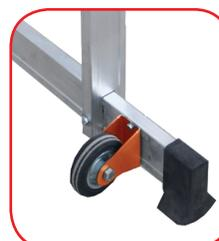
**BASE IN ACCIAIO OPTIONAL:** Lunghezza cm 93 - 4 ruote Ø 100 con freno Peso totale Kg 9. Con l'uso della base il trabattello si alza di mm 85 rispetto allo standard.
