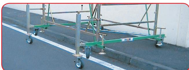
Grazie al sistema telescopico, serve a livellare il trabattello consentendone lo spostamento in presenza di marciapiedi o leggero pendio. Rapido da montare e molto stabile, è costruito in acciaio, pesa Kg 12,5 ed è dotato di ruota Ø 200 mm con freno. Regolazione 50 cm. (In fase di lavoro si ha comunque l'obbligo di montare le 4 staffe stabilizzatrici).
