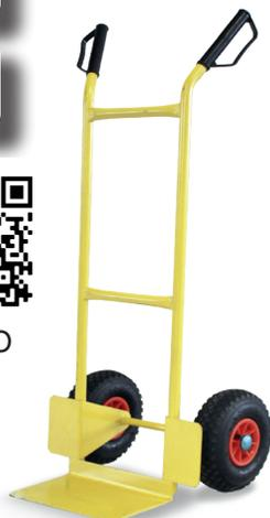
**Carrello portapacchi.** Carrello in acciaio verniciato con polveri epossidiche. Dotato di manopole anti infortunistiche con paramano di sicurezza. Gomme pneumatiche con portata cad. Kg 100, Ø 260 mm con mozzo in plastica e cuscinetti a rulli. La struttura è costituita da robusti tubolari saldati con Ø 25 mm.
