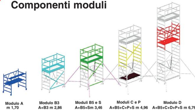
**Modulo A:** n.1 modulo richiudibile (5 gr) dotato di n.4 ruote pivotanti con freno  $\varnothing$  125, n.1 piano con botola, (solo per Roller Plus L n.1 mezzo piano cieco).
