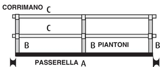
Il set parapetto è di rapido montaggio ed è costituito da 2 piantoni B e 2 corrimano C per ogni lato (eccetto per i modelli BR06, BR07 e BR08 che hanno 3 piantoni).
