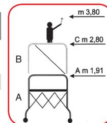
**NORMATIVE E COLLAUDI:** Aladin e Baby sono costruiti in conformità al D.LGS81/2008 per l'utilizzo nei luoghi di lavoro. I trabattelli sono stati sottoposti a test interni fra i quali test di portata e di ribaltamento, documentati e certificati per poterne dichiarare la conformità al D.Lgs.81/2008 come indicato dalla guida tecnica INAIL del 2022. La portata di Kg 110 è stata collaudata positivamente. Leggere il manuale per tutte le indicazioni di sicurezza.
