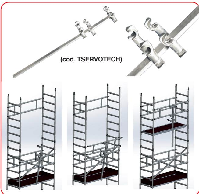
Nuovo accessorio che consente il montaggio/smontaggio in sicurezza dei parapetti di protezione stando con i piedi sul piano inferiore come indicato dalla norma europea EN1004.1. Montati i parapetti, l'operatore sale sul piano superiore in totale sicurezza protetto su tutti i lati.
