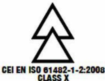
Tensione di prova 400 V c.a. Durate dell'arco 500 ms
